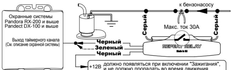
В режиме программирования "Зеленый" провод соединить с выходом таймерного канала, после успешного программирования "Зеленый" провод отсоединить и заизолировать
